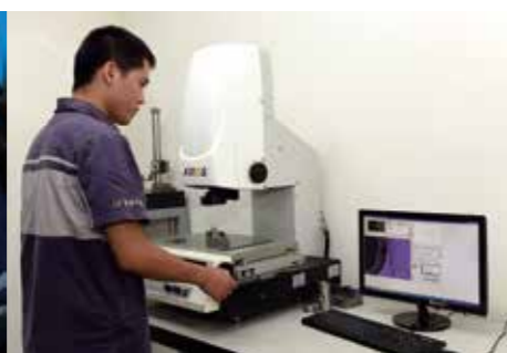
▲ 品質管控：量測投影機
